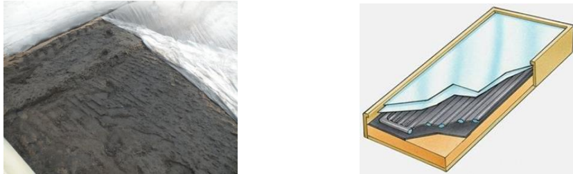
Fig. 1 – Schema di un comune pannello solare termico associato al nuovo impianto di solarizzazione del suolo.
